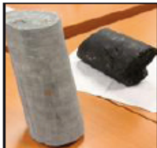
À gauche une carotte de schiste, à droite un échantillon de houille. Photo Philippe REDINGER
